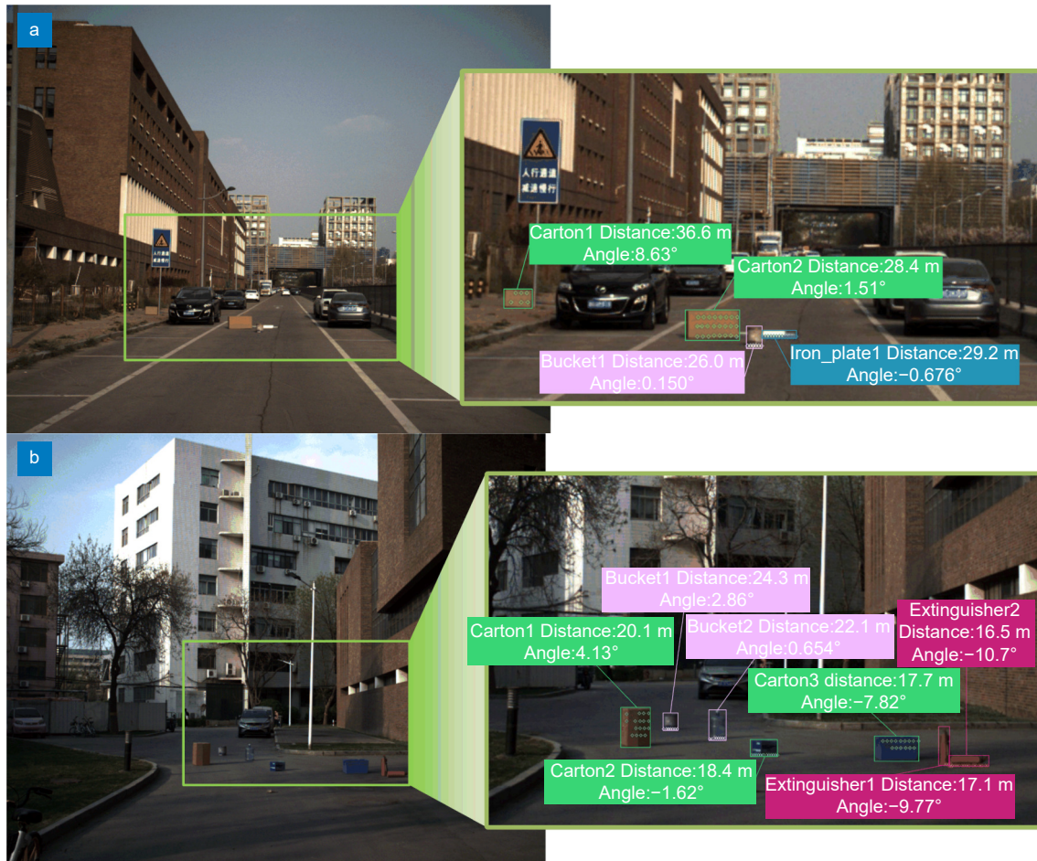
图 11 公路洒落物检测与定位实验结果。(a) 场景一; (b) 场景二
