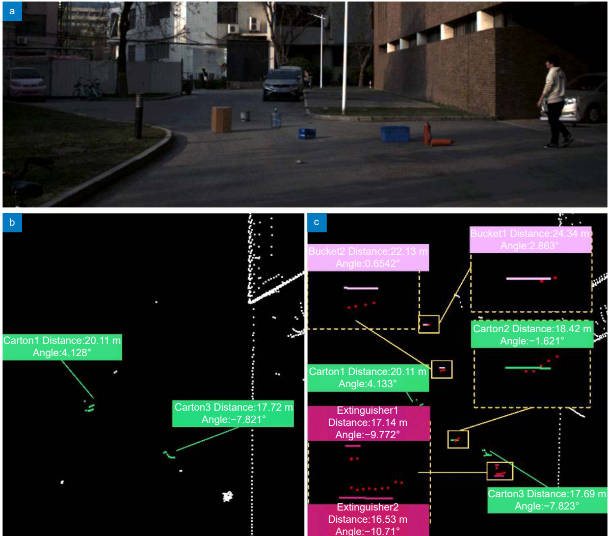
图 10 公路洒落物检测定位结果 (场景二, 截取部分区域)。 (a) 待测场景图像; (b) Method A 的检测定位结果; (c) 本文所提算法的检测定位结果
