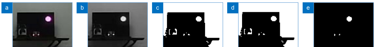
图 8 使用不同阈值处理方式得到的图像。(a) 原图像; (b) 灰度图像; (c) 迭代法; (d) Otsu 法; (e) 基于灰度直方图的阈值分割法, 最终阈值为 133
