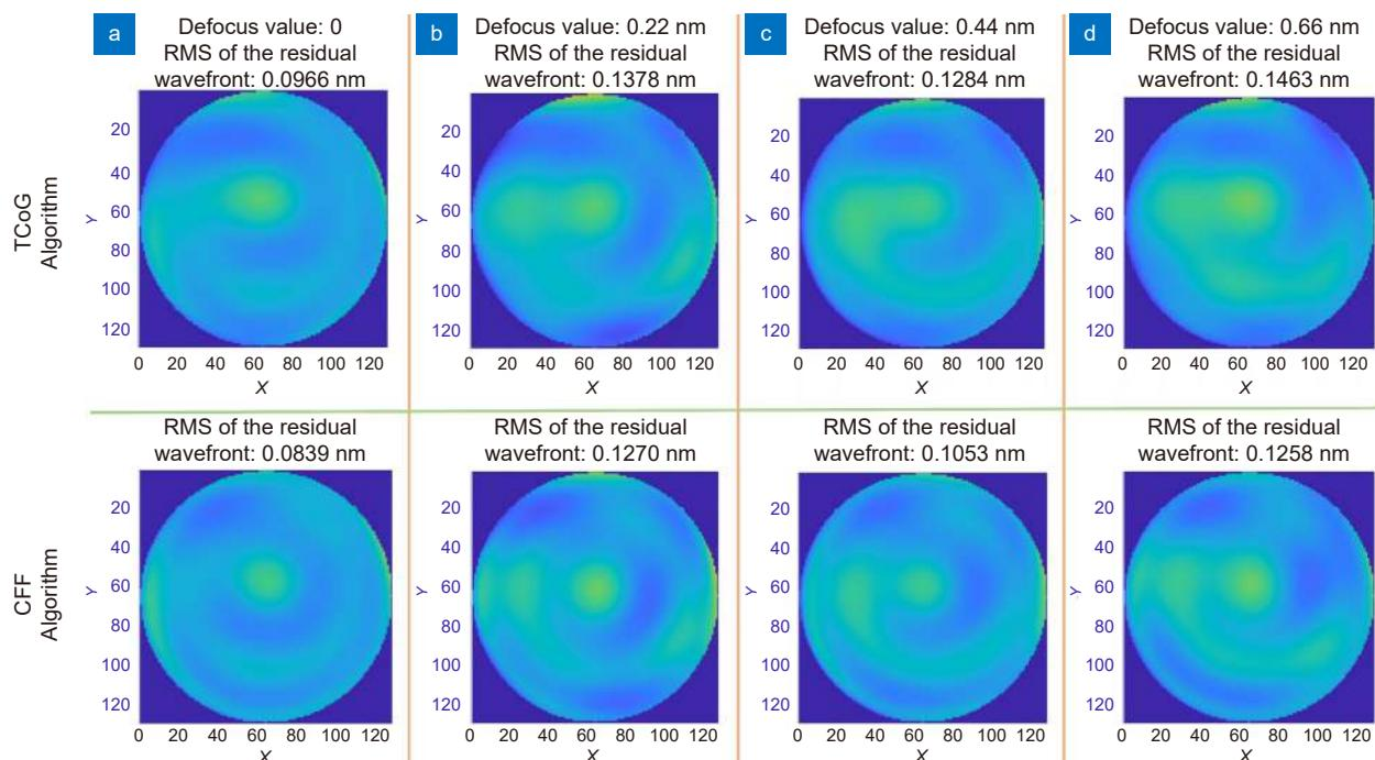
图 11 互相关算法和质心算法通过复原后得到的残余波面。实际离焦值分别为
