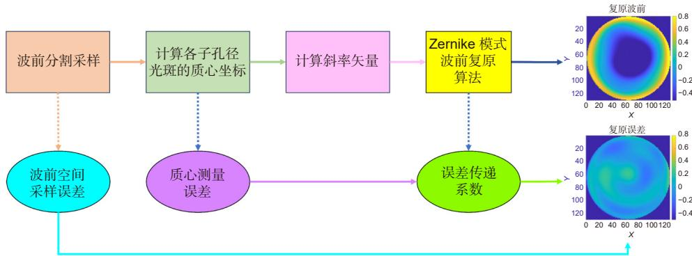
图 4 波前复原流程及复原误差的组成
