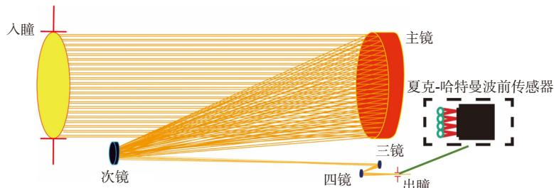
图 1 天琴计划的星载望远镜的光学布局设计
