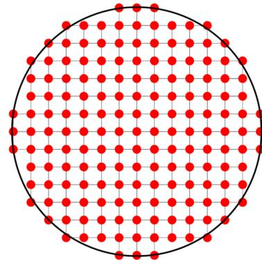
图 6 点源图像的有效子孔径分布
