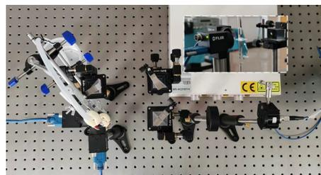
**摘要:** 针对已有单波长方法测量小通道竖直上升气液两相气泡流相分布参数误差较大的问题, 提出了用双波长透射法进行测量研究。通过几何光学原理计算双波长激光经过气液两相流的光强分布, 然后提取双波长光强分布特征量, 建立了一种基于双波长测量理论的气泡流相分布参数识别模型。利用 Trace Pro 模拟 445 nm、635 nm 的激光经过位于管道截面不同位置处的不同尺寸气泡时, 得到相应光强分布曲线并提取出特征量, 使用仿真得到的特征量数据集对神经网络进行训练, 将训练好的神经网络用来预测实验中气泡流的相分布。仿真实验结果表明, 建立的模型对气泡中心位置、半径预测的平均绝对误差分别为 0.018 mm、0.007 mm, 均优于单波长方法, 证明了所建模型的有效性和准确性。在搭建的实验平台进行了气泡流测量, 重建了气泡流的三维图。
