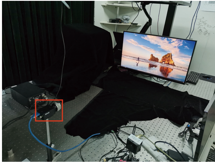
图 3 整体硬件系统 (红色方框内为传感器)
