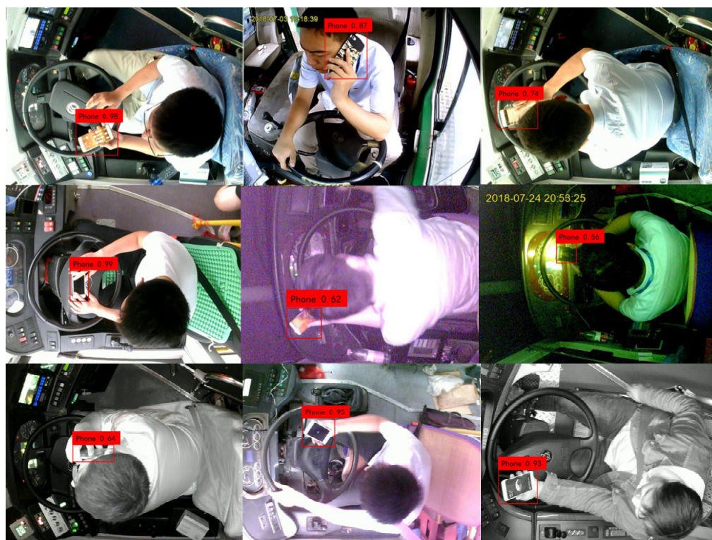
图 6 复杂的驾驶场景下的检测结果
