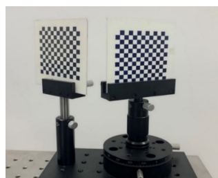
图 4 双棋盘格标定板 Fig. 4 Double checkerboard calibration board
