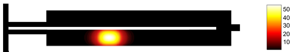
图3 仿真得到的对称型 OTMA 膨胀臂的温升分布
