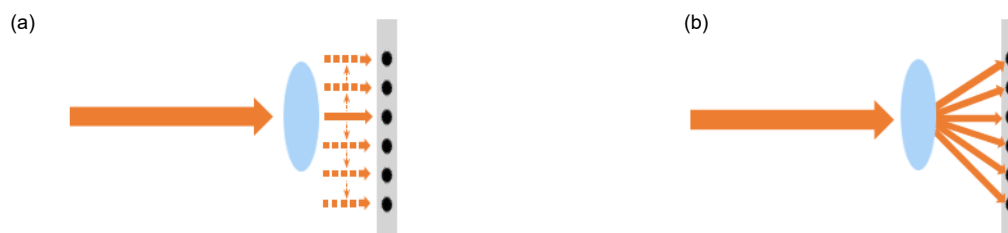
图 1 单光束与多光束工作原理图
