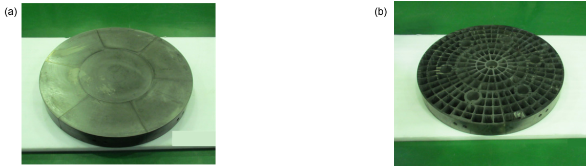
图3 1.0 m口径碳化硅拼接技术验证镜照片。(a) 镜面; (b) 背面
