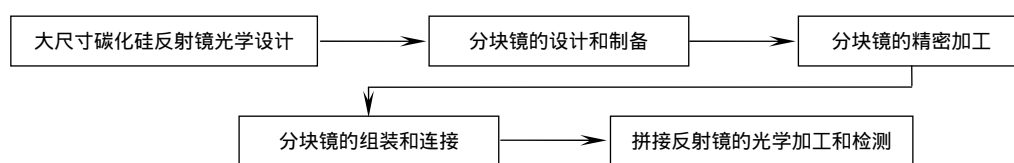
图 1 大尺寸碳化硅拼接式反射镜的制备技术路线
