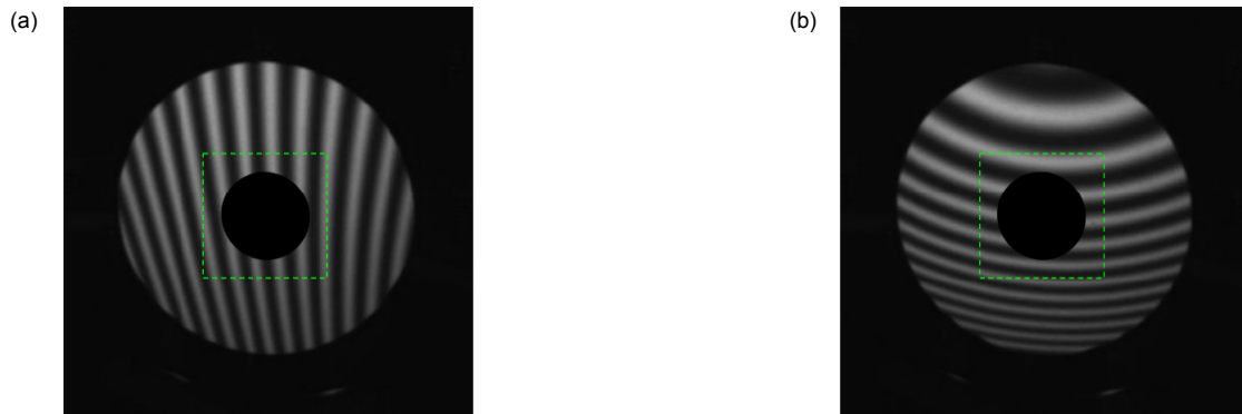
图 15 中空离轴抛物面镜的纵横变形条纹。(a) 纵向; (b) 横向
