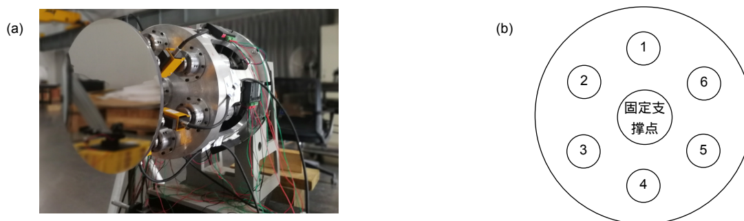
图5 被测预应力薄镜。(a) 薄镜旋转支撑结构侧视图; (b) 薄镜背面支撑点位置分布示意图
