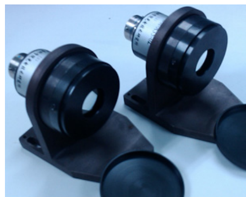
图 14 人眼视网膜成像系统使用的 9 单元、35 单元双压电片变形镜
