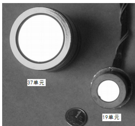
图 13 早期人眼视网膜成像系统使用的 19 单元、37 单元变形镜 [21]
