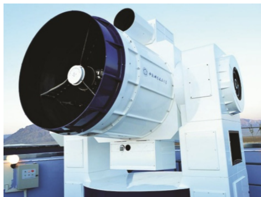
图 9 1.2 m 墨子号通信望远镜 [76]
