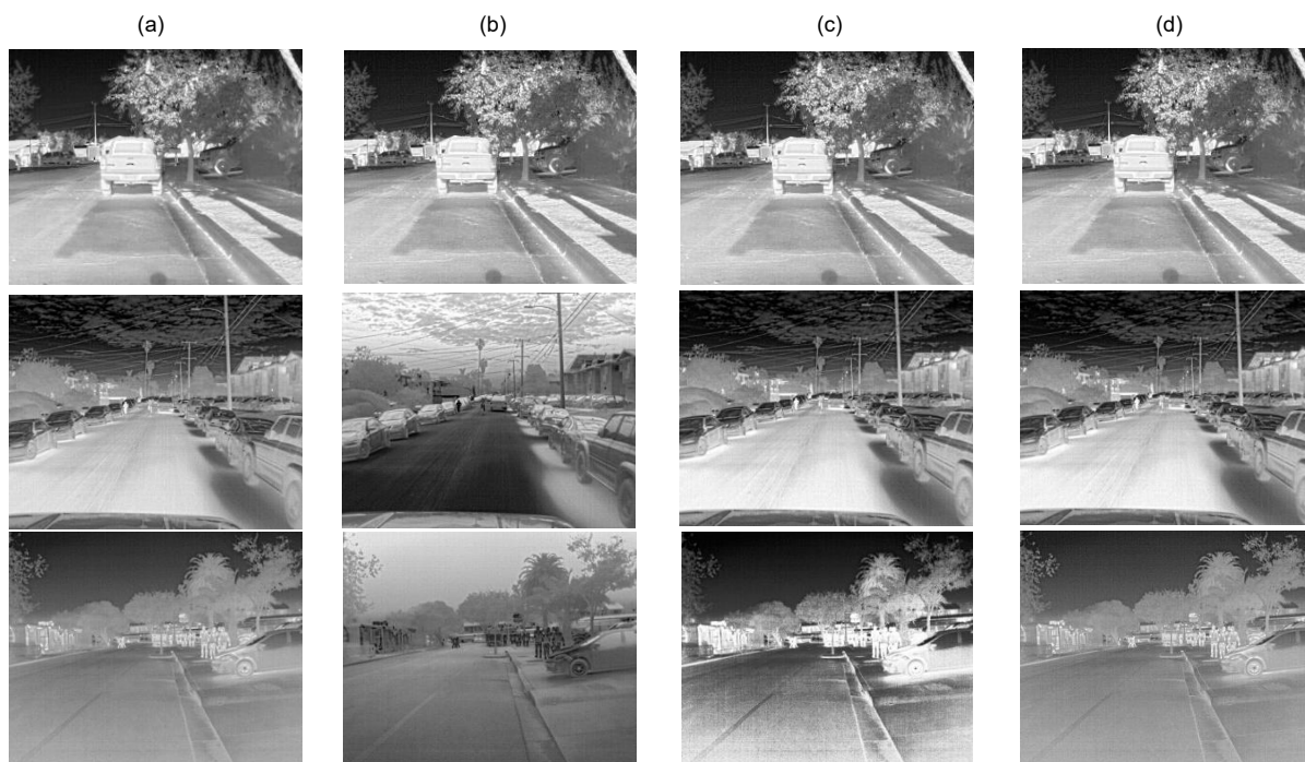
图 1 来自 FLIR 数据集的不同红外图片(每行)。(a) 原图; (b) 倒置; (c) 直方图均衡; (d) 去噪+图像锐化
