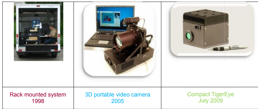
图 8 Flash 激光雷达小型化发展过程 [23] Fig. 8 Miniaturization evolution of Flash LiDAR [23]
