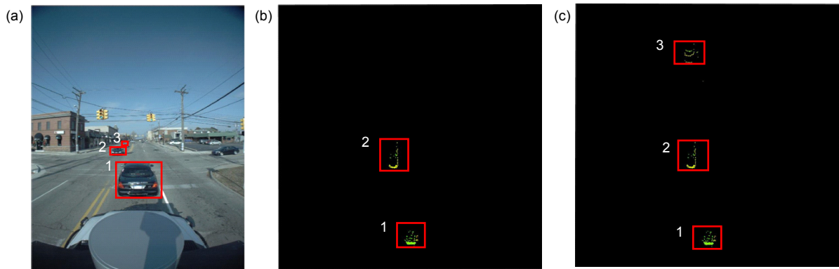
图 7 三距离障碍物检测实验。(a) 数据采集场景; (b) 传统 DBSCAN 聚类算法效果; (c) 优化 DBSCAN 聚类效果
