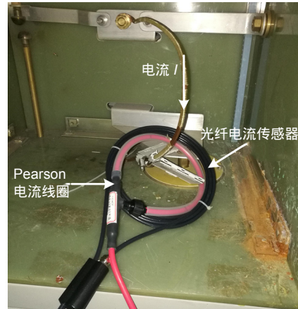
图 7 雷电流 8/20 μs 波形测量
