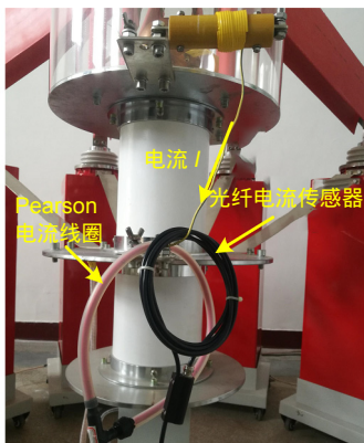
图 2 雷电流 A 波波形测量
