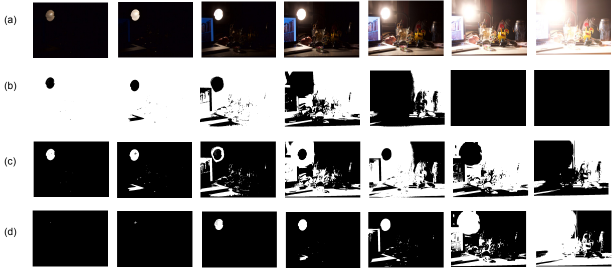
图 2 亮度分区图。(a) 不同曝光的 LDR 图像; (b) 低亮度图像; (c) 中间亮度图像; (d) 高亮度图像
