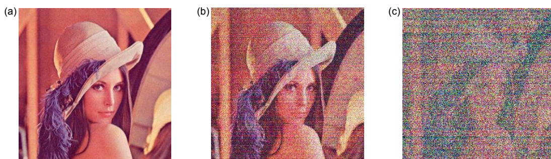
图 8 加密图像受到噪声攻击时的解密图像。(a) 噪声攻击强度为 0.001 时的解密图像; (b) 噪声攻击强度为 0.01 时的解密图像; (c) 噪声攻击强度为 0.1 时的解密图像
