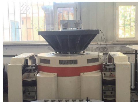
图 17 主镜组件 Z 向正弦扫频试验现场
