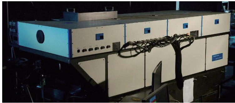
图 6 151 单元高阶 AO 系统与 1 m 新真空望远镜对接实物图 Fig. 6 The photo of 151-element solar AO system
