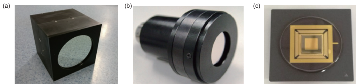
图 15 IOE 研制的几种小型变形镜。(a) 分立式驱动器，1085 单元间距 3\ \text{mm} ；(b) Bimorph 变形镜，35 单元，间距 3\ \text{mm} ；(c) MEMS 变形镜 140 单元，间距 0.4\ \text{mm} 。(图均由光电所提供)
