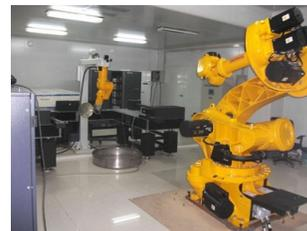
**摘要:** 针对目前国内激光冲击强化设备工业化程度不高的问题, 采用固定光路系统结构形式和模块化设计方法, 研制了一款激光冲击强化设备。分析了激光冲击强化设备的设计方案、激光光路布置特点以及系统控制方法, 并对激光冲击强化设备技术指标进行了测试。保持室温在 $(22\pm 2)$  °C以内, 设备开机 20 min 后, 输出最大脉冲能量可达 25 J, 能量波动范围不超过 3%, 脉宽在 16 ns~20 ns 之间连续可调, 波动范围在 -1 ns~1 ns 以内, 光束的发散角小于 2.5 mrad, 光束指向波动小于 50  $\mu$ rad, 重复频率 0.5 Hz~5 Hz 可调, 光路系统的传输效率约为 92%, 约束层厚度均匀、且流量连续可控。测试结果表明, 激光冲击强化设备的各项性能良好。
