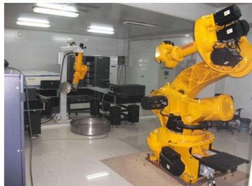
图7 激光冲击强化设备实物图.
