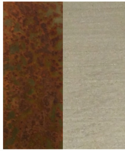
图 3 试样经激光除锈前后的效果对比。
