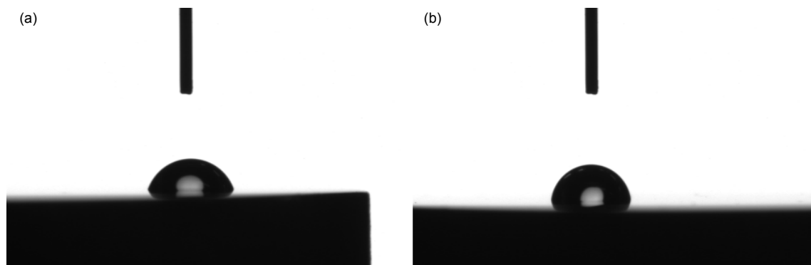
图 11 \text{As}_2\text{Se}_3 玻璃未制备与制备微结构区域的表面静态接触角. (a) 未刻蚀区域. (b) 刻蚀区域.
