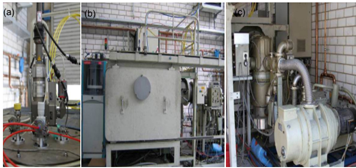
图 12 真空激光焊接设备 [29] . (a) 激光头. (b) 真空舱. (c) 抽真空装置.
