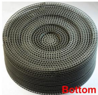
图7 微波段三维地毯式隐身罩 [19] 。
