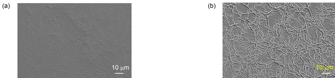
图 2 (a) PDLC 薄膜的 SEM 图; (b) 纳米 ZnO 棒掺杂的 PDLC 的 SEM 图 Fig. 2 (a) SEM diagrams of PDLC films; (b) SEM diagrams of nano-ZnO rods doped PDLC films
