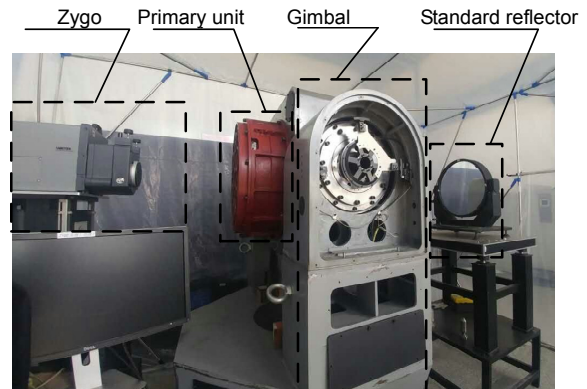
图 8 面形检测现场 Fig. 8 Mirror-shape error detection
